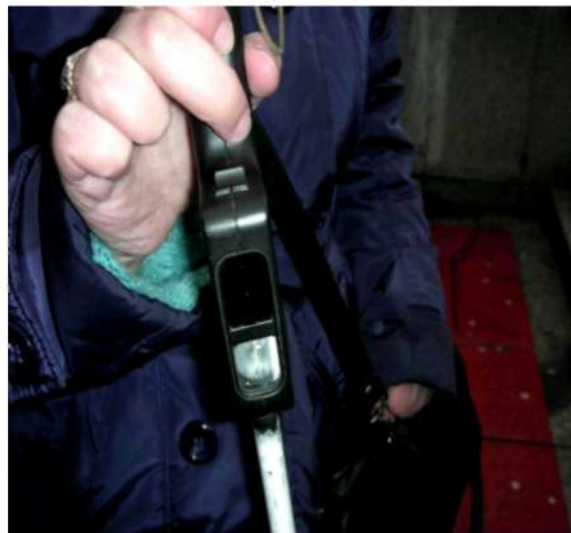
Detektor fal ultradźwiękowych umieszczony u nasady laski (fot. D. Zawadzka)
